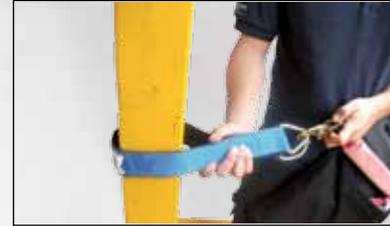
**Extraiga la cinta de la bolsa y fije un extremo a un punto de anclaje adecuado.**
